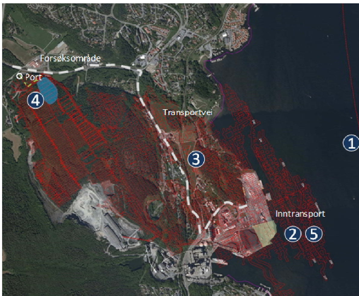
Figur 2.3: Adkomstvei fra kai til gruve. 1: Atkomst med skip, 2: Overføring av avfall fra skip til bil på kai, 3: Atkomstvei fra kai til gruve, 4: Forsøksområde i gruve (markert med blått), 5: Retur av avfall etter endt forsøk, dvs overføring av avfall fra bil på kai til skip.
